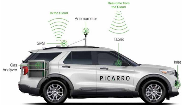
Die fahrzeuggestützte Analytik ermöglicht eine großflächige Erhebung von Messdaten zur Abbildung vorhandener Methanemissionen auf dem Verteilnetz. Diese Daten bilden die Grundlage für weiterführende Datenanalysen und zur Darstellung von Leckstellenverdachtsflächen (LISAs).
